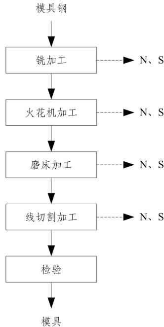
图 2-2 模具加工工艺流程及产污环节图
