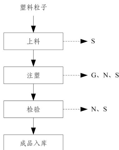
图 2-3 医疗器械生产工艺流程及产污环节图
